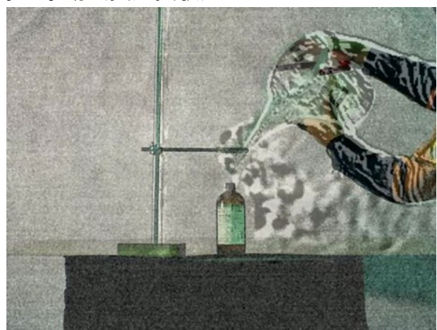
図11：漏斗を用いて詰め替える際の可燃性蒸気の挙動
