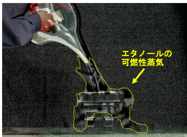
図8：エタノールを注入した際の可燃性蒸気の挙動 (シャーレ・常温(20℃))
